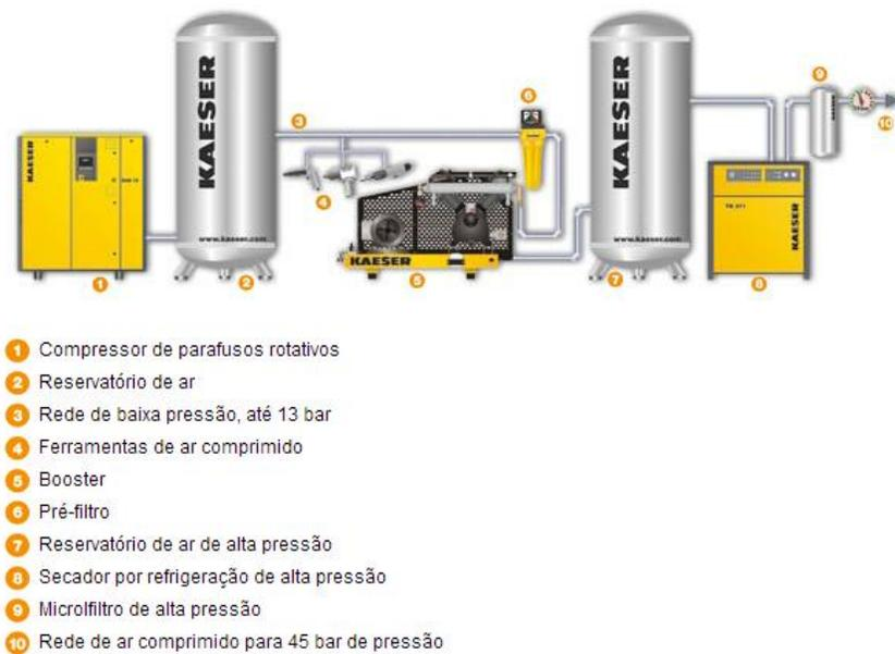
**Figura 10 Exemplo de sistema de ar comprimido comercial de alta pressão**
