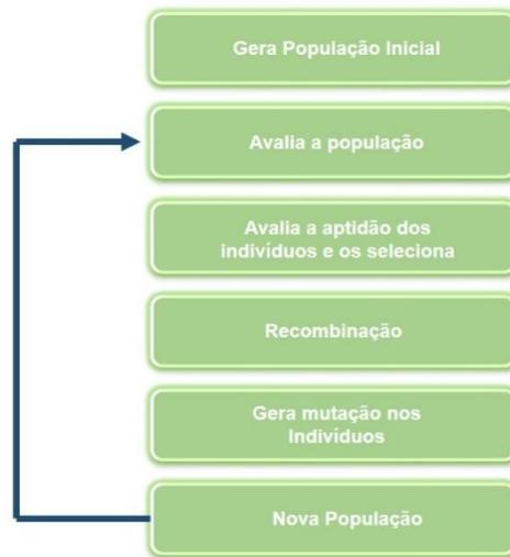
Figura 2.7 – Esquema utilizado para gerar o algoritmo genético
