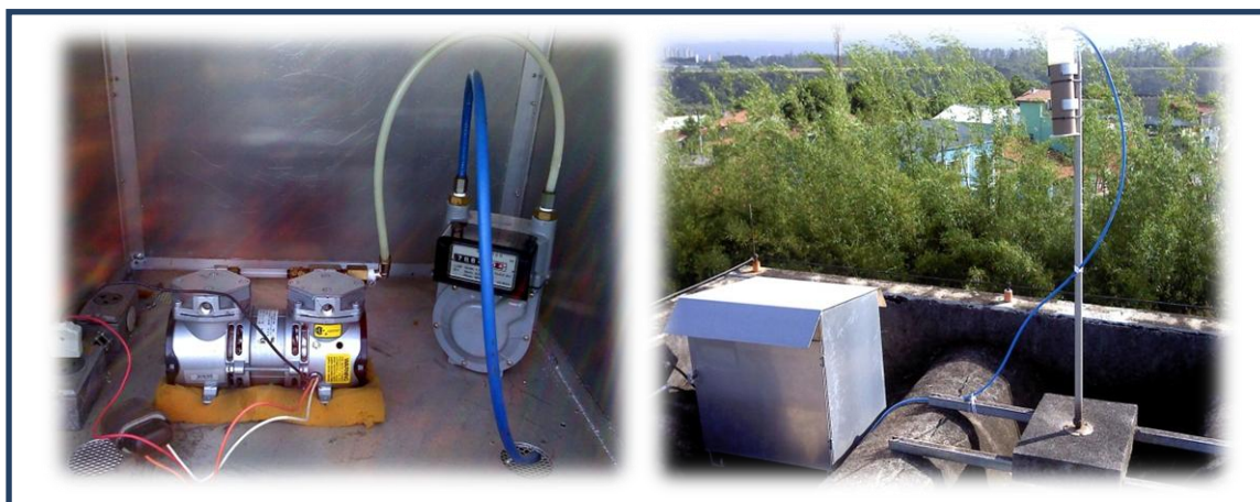
Figura 2: Foto do medidor de volume e bomba de vácuo isenta de óleo a esquerda. Foto do amostrador dicotômico a direita; Autora: Mariana de A. Souza (04/11/2011)
