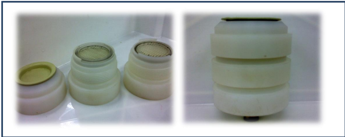
Figura 3: Porta filtro desmontado e Porta filtro montado; Autora: Mariana de A. Souza (16/07/2012)
