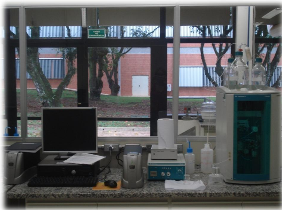
Figura 4: Foto Cromatógrafo líquido de troca iônica; Autor (a): Roberta Lee M. Alcaide (2011) INPE – SJC
