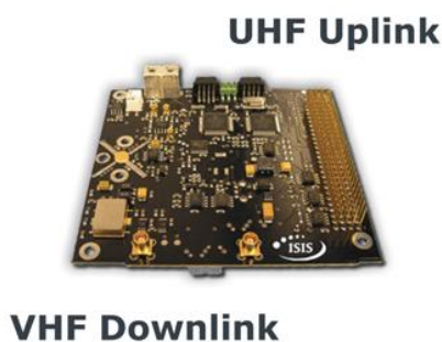
Figura 5 – Transceptor TRXUV1200A desenvolvido pela empresa ISIS
