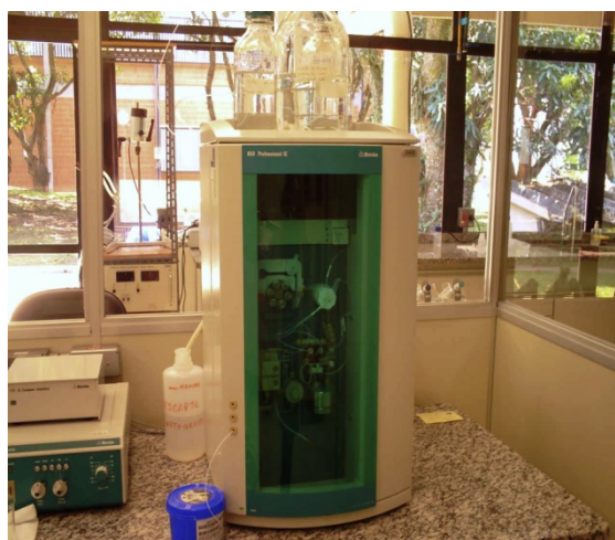
Figura 4 – Foto Cromatógrafo líquido de troca iônica -; Autor(a) : Aline C. Monteiro (25/01/2011) INPE – SJC
