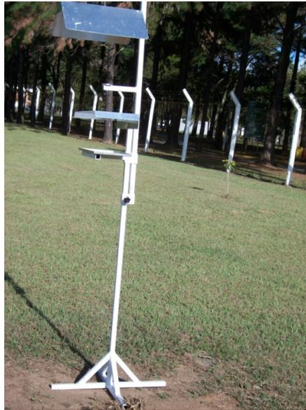
Figura 2 – Ilustração do suporte para proteção e instalação do coletor de material particulado.
