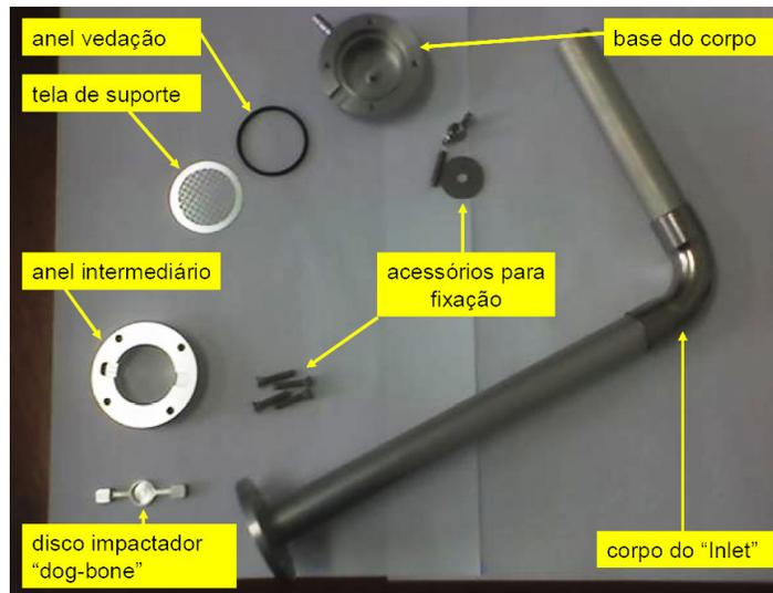
Figura 4 – Componentes do impactador e disco suporte do filtro coletor
