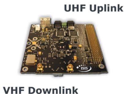
Figura 2.2 – Transceptor TRXUV1200A desenvolvido pela empresa ISIS
