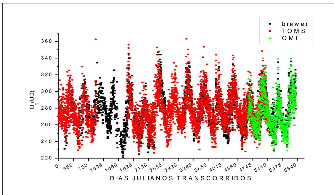
Fig. 6.1 - Comparação entre a coluna total de ozônio fornecida pelos equipamentos Espectrofotômetro Brewer (em preto), pelo sensor TOMS (em vermelho) e pelo instrumento OMI (em verde), no período de
