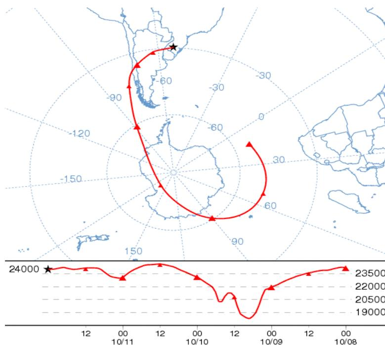
Fig. 6.12 – Trajetória retroativa (backtrajectory – Modelo HYSPLIT) dos ventos mostrando a origem polar de massas de ar sobre o Observatório Espacial do Sul, dia 12 de outubro de 2005 a 24 km.
