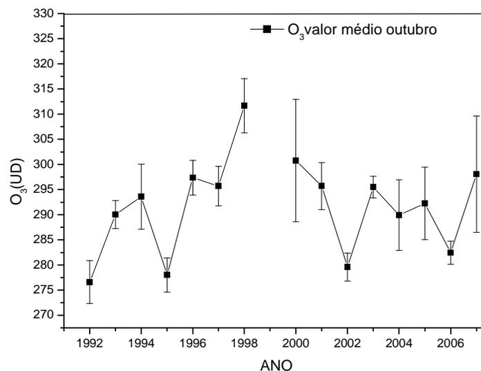
Fig. 6.3 – Dados da coluna total de ozônio do Espectrofotômetro Brewer para o Observatório Espacial do Sul, valores médios dos outubro de 1992 a 2006.
