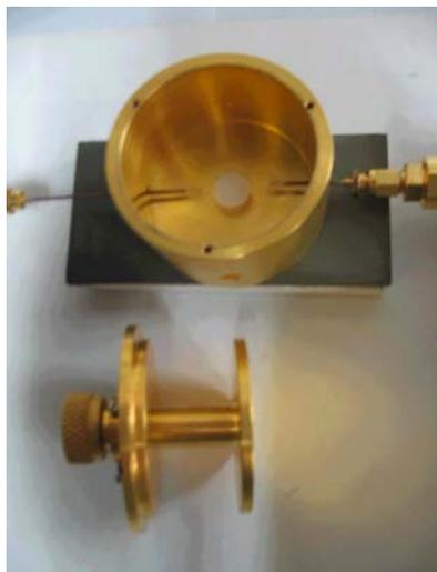
FIGURA 6 – Vista da caixa de teste blindada para determinar a frequência de ressonância.
