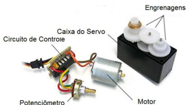
**Figura. 6** – Servo motor e suas partes <sup>4</sup>
