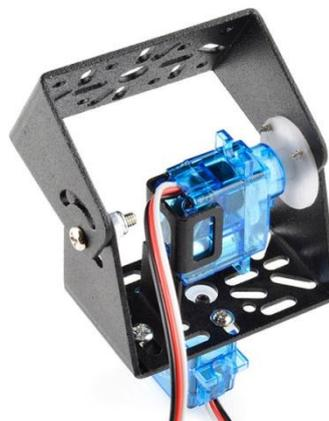
**Figura 8** – PAN/TILT e Servos Motores
