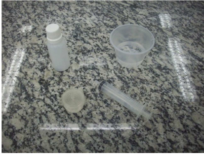
Figura 4 Processo de filtração da solução aquosa: siringa, porta filtro e extrato aquoso do particulado.
