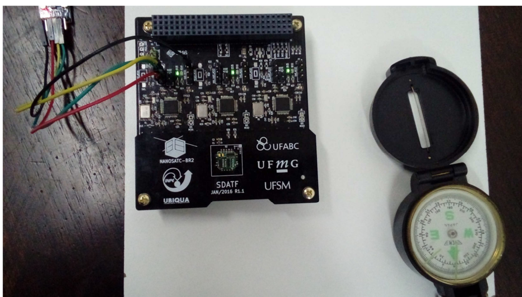
Figura 5.9 – Setup de teste de comunicação entre SDATF e o OBC-P STM32
