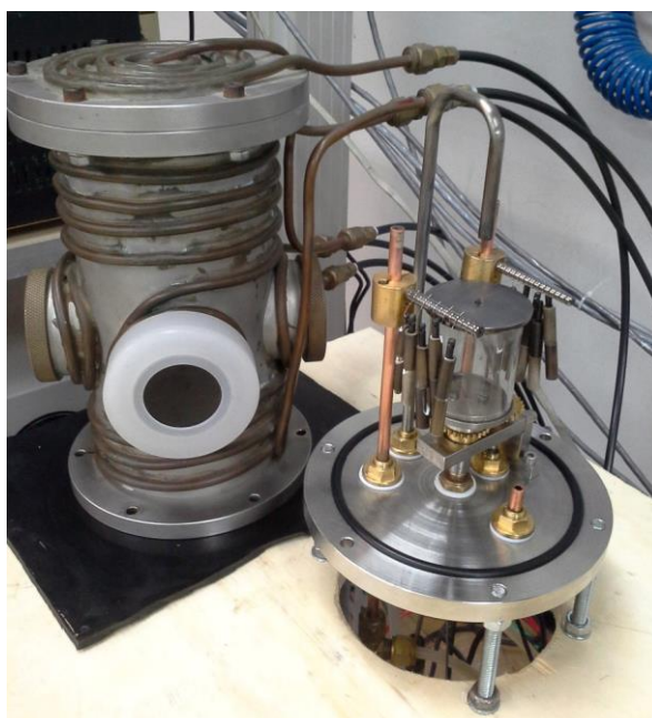
Figura 3.1 – Reator de crescimento de filmes de diamante.
