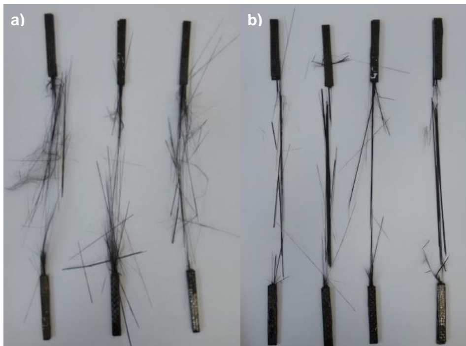
Figura 4.10 – Corpos de prova após ensaio de tração longitudinal de: a) fibras puras e b) com crescimento de NTCs.
