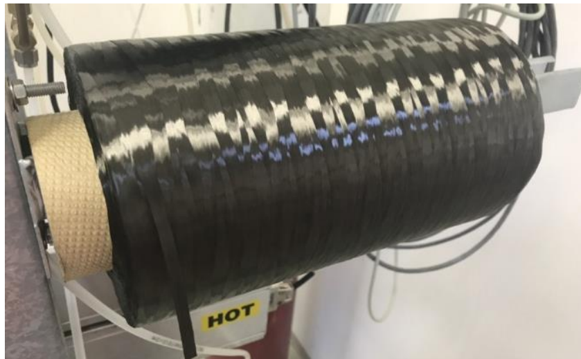
Figura 3.1 – Fibra de Carbono Unidirecional.
