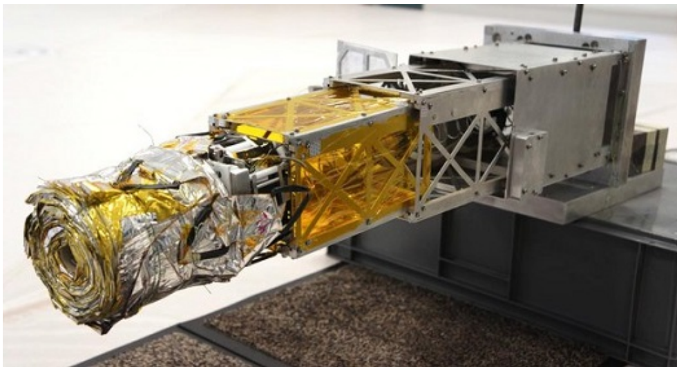
Figura 2.2 - Foto do teste de abertura da Gossamer Deorbit Sail
