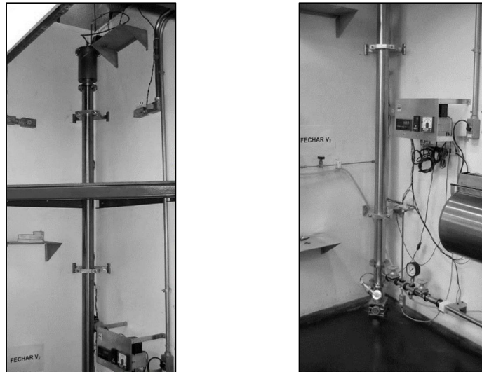
Figura 2.9 - Tubo de queda-livre do Laboratório Associado de Sensores e Materiais (LAS) / INPE.
