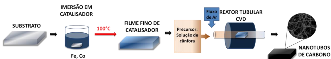
Figura 3.1 - Esquema do processo de síntese dos CNTs por método CVD.
