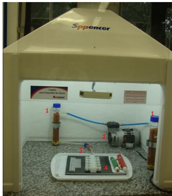
Figura 6: Sistema de secagem de denuderes montado na capela (1. Compartimentos com sílica gel laranja; 2. Bomba; 3. Filtros de linhas caráter ácido e alcalino e 4. Manifold para conectar os denuderes).
