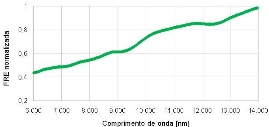
Figura 5.4 - Função de Resposta Espectral do detector Judson ( FRE_{ref} ) em função do comprimento de onda ( \lambda ).
