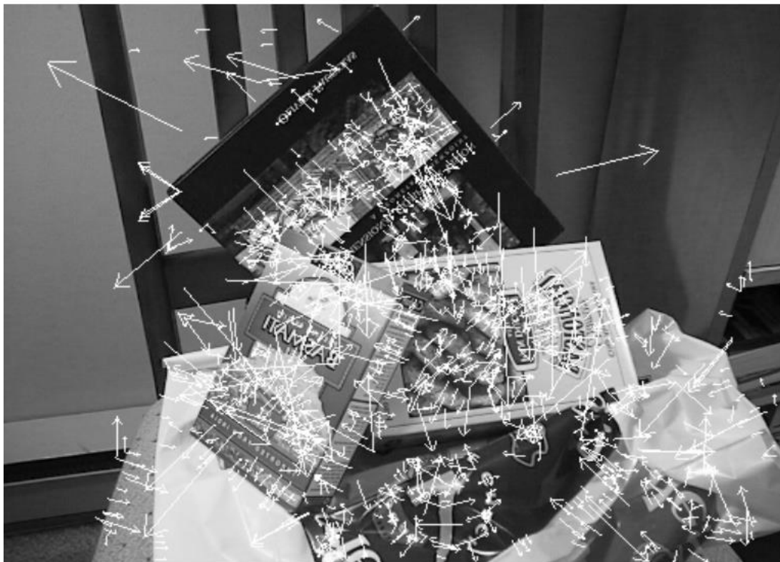
Figura 2.12 - Exemplo de seleção de pontos chaves em uma imagem, onde eles são representados por vetores que fornecem informações sobre a localização, magnitude e orientação.
