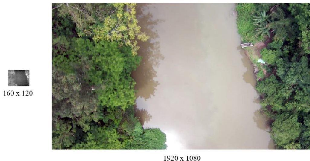
Figura 5.12 - Par de imagens TIR e RGB obtidas pela câmera FLIR Duo em suas dimensões originais.
