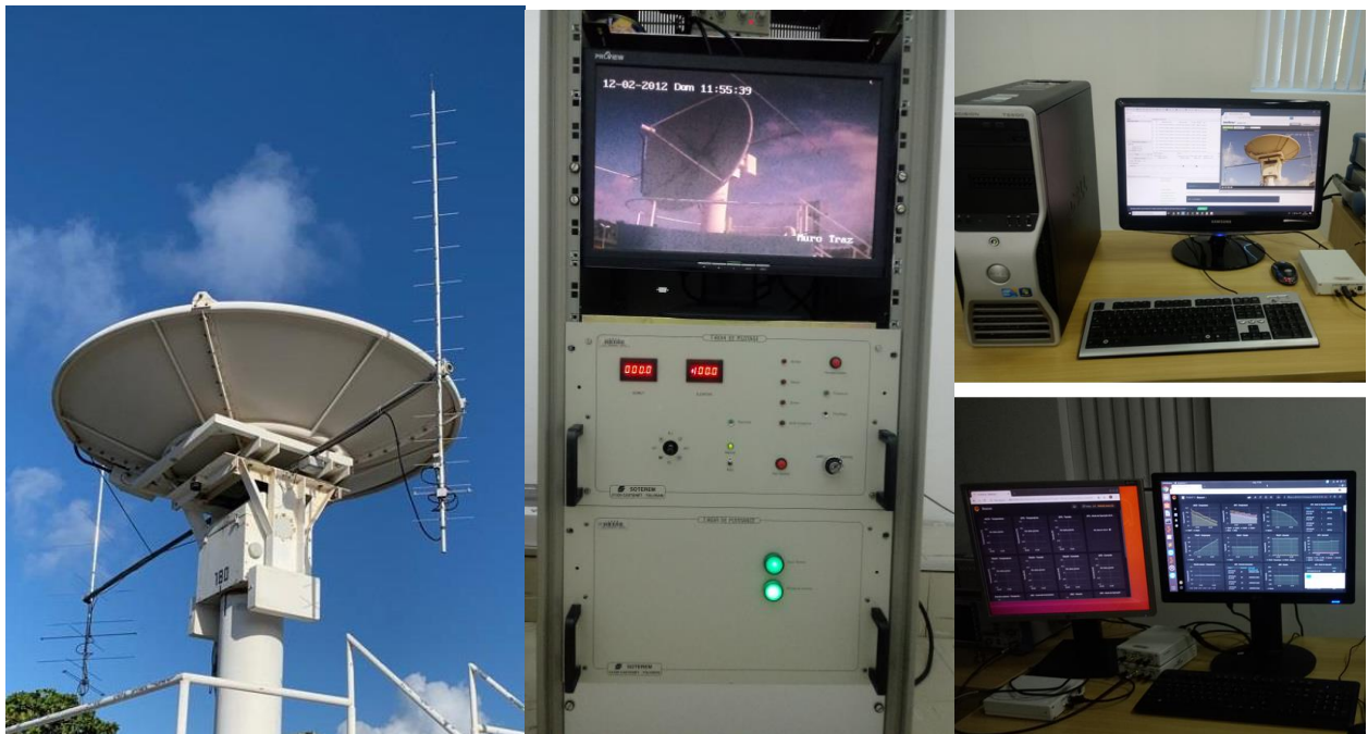
Figura 6. Antena, Unidade Interna e Controle da EMMN (Estação MultiMissão de Natal) (Fonte: cortesia da equipe EMMN)
