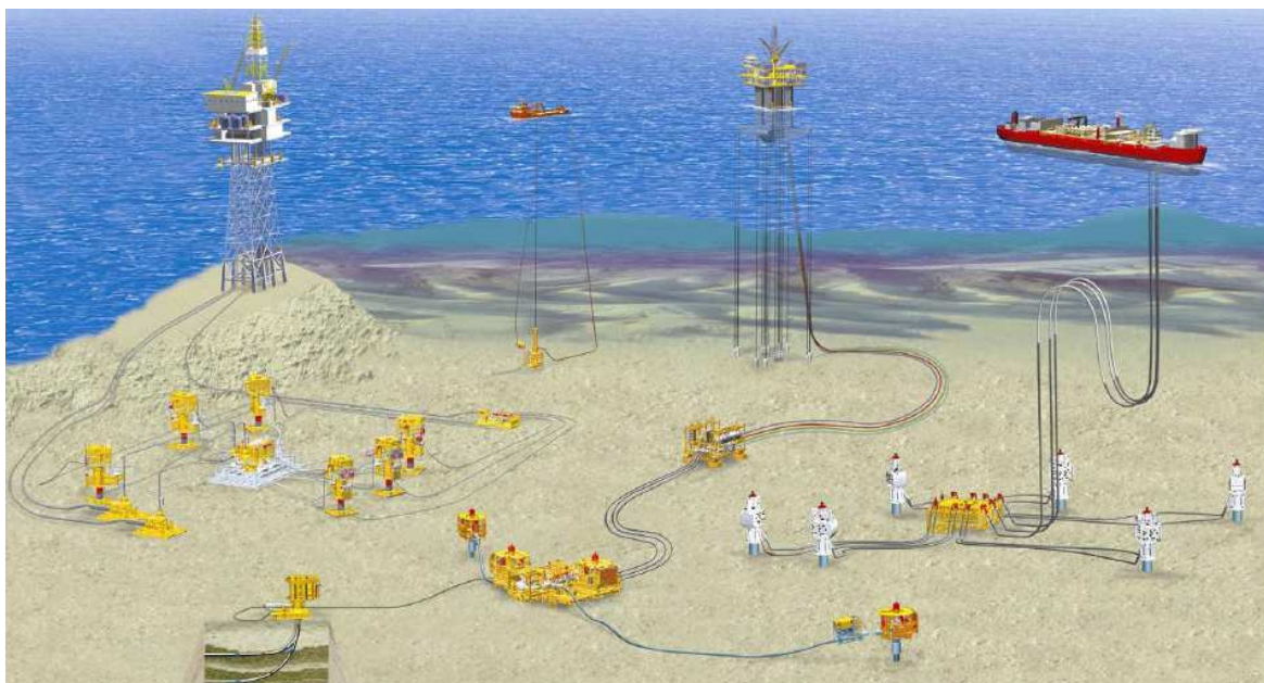
Figura 1.1 - Esquema de um sistema de produção de petróleo em alto-mar.
