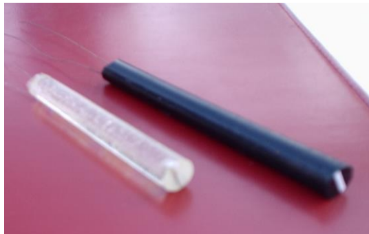
Figura 3.3 – Sensores de cerâmica porosa de \text{TiO}_2\text{-ZrO}_2 para monitoramento da umidade relativa de solos, desenvolvidos no TECAMB.
