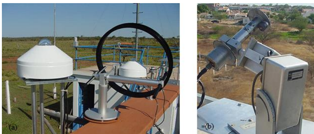
Figure 7 - (a) Piranômetros sem e com a banda de sombreamento e (b) Pireliômetro da Estação de Cachoeira Paulista. Fonte: INPE (2016).
