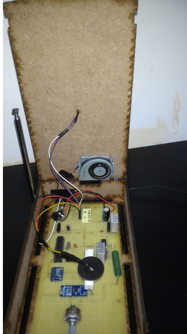
Figura 3.7 - Radiômetro completamente montado com todos os termistores.
