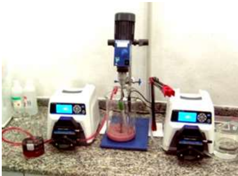
Figura 2 – Esquema utilizado para a síntese por coprecipitação
