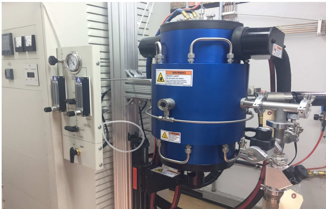
Figura 1- Forno modelo 1000-2560-FP24 utilizado para o tratamento de fibras de carbono em alta temperatura.
