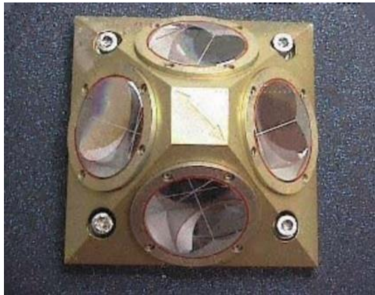
Figura 2.5: Instrumento Laser Retro Reflector (LRR). Fonte: Esa (2004).
