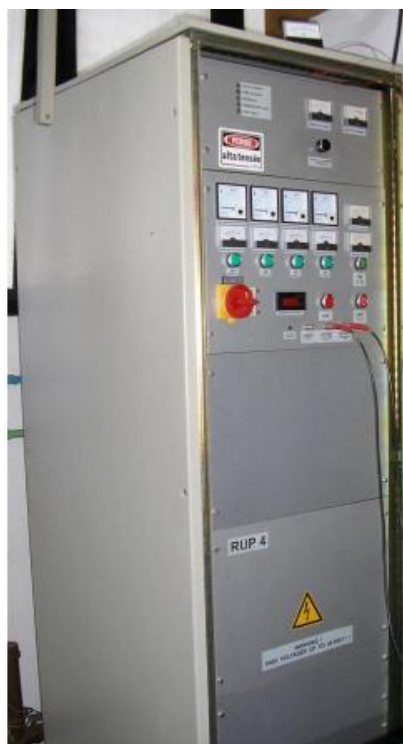
Figura 4.2 Fotografia do Pulsador de alta tensão negativa RUP-4.
