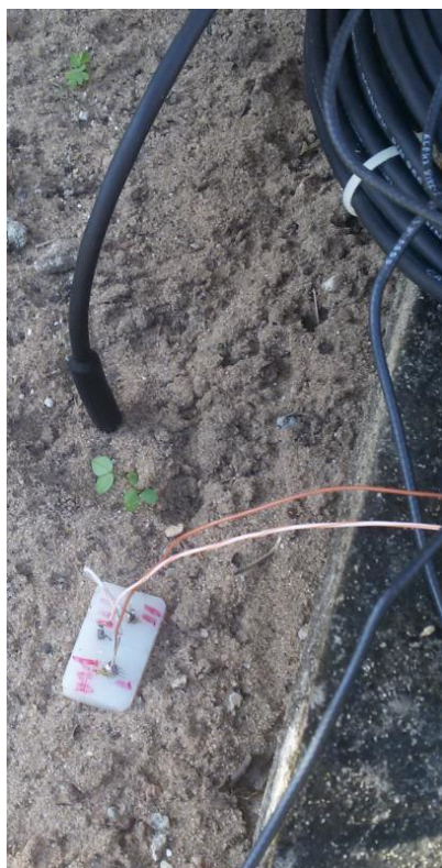
Figura 17- Sensores de temperatura e umidade do solo
