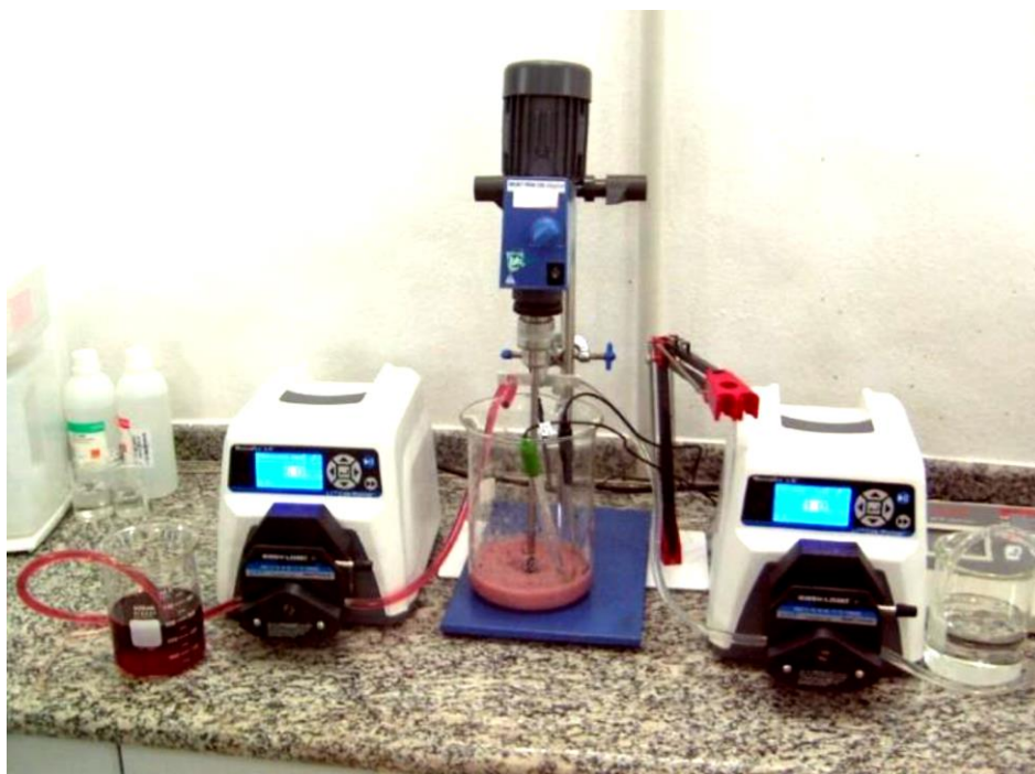
Figura 2.2.1 : Fotografia do sistema de síntese por coprecipitação
