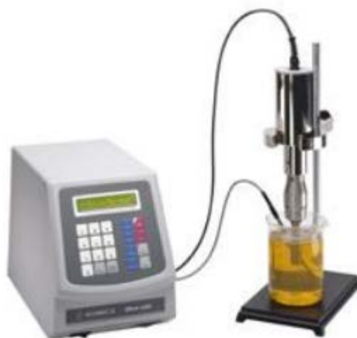
Figura 3.1 - Representação esquemática da montagem do equipamento Sonics VCX-750 para síntese das amostras.
