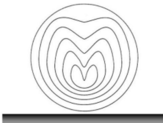
Figura 2.1 - Formação de um micro jato líquido durante o colapso de uma bolha próxima a uma superfície sólida (1,9) .
