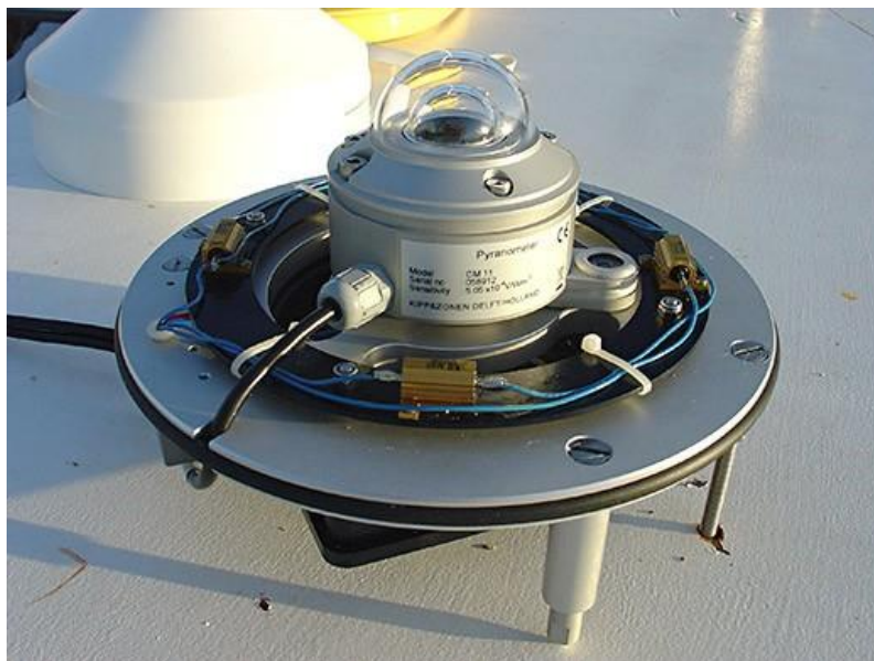
Figura 10 - Piranômetro de radiação global aberto.
