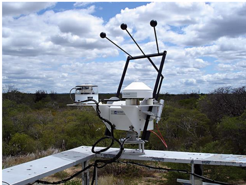
Figura 14 - Rastreador solar com 3 sensores da Estação de Petrolina.
