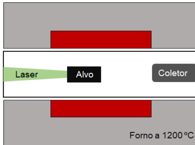
Figura 2.10 - Crescimento por ablação a laser.
