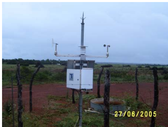
Figura 1: Foto de uma PCD em campo com seus sensores
