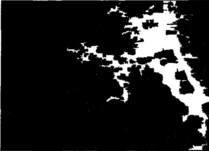
Fig. 3.8 - Um dos fatiamentos de MNTs realizados. Pode-se observar nas partes mais claras a estipulada área de inundação do reservatório (cota 72).
