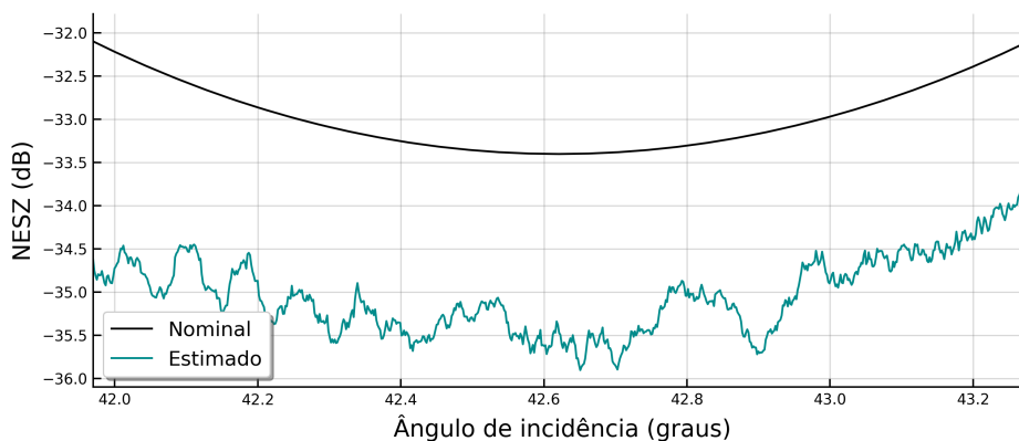
Figura B.7 - Comparativo entre o NESZ nominal (curva em preto) e o NESZ estimado através do método proposto em Hajnsek et al. (2003) (curva em ciano), ao longo de um transecto na direção de alcance para o dia 8 de Maio de 2010 (em dB). O transecto é indicado como a linha azul na Figura A.7
