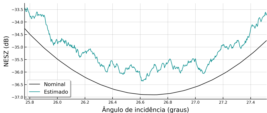
Figura B.3 - Comparativo entre o NESZ nominal (curva em preto) e o NESZ estimado através do método proposto em Hajnsek et al. (2003) (curva em ciano), ao longo de um transecto na direção de alcance para o dia 14 de Dezembro de 2009 (em dB). O transecto é indicado como a linha azul na Figura A.3
