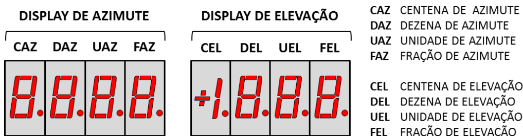
Figura 61. Displays da Unidade de Pilotagem
