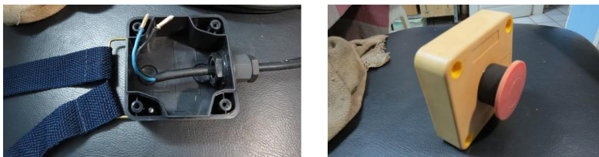
Figura 10. Botão de Parada de Emergência
