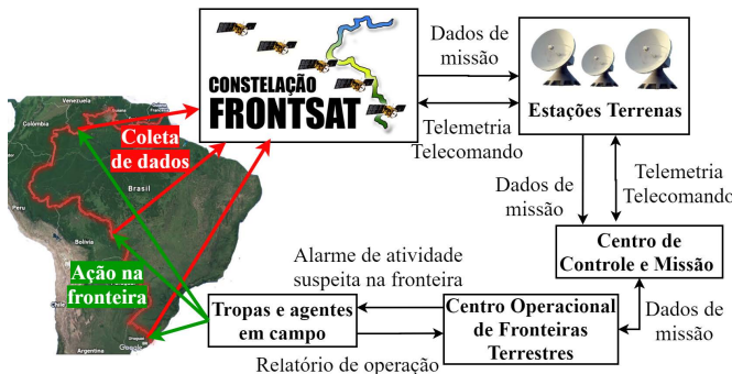
Fig. 4. Arquitetura operacional do sistema FrontSat.
