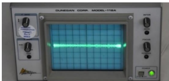
Fig. 7 – Sinal obtido no osciloscópio no Teste de PIND
