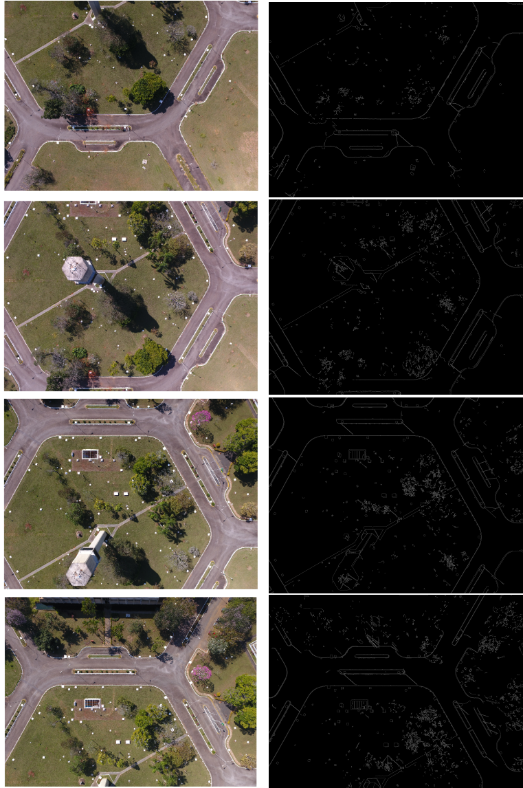
(a) As imagens estão em pares, à esquerda está a imagem capturada pela câmera embarcada e à direita a respectiva imagem com bordas extraídas.
