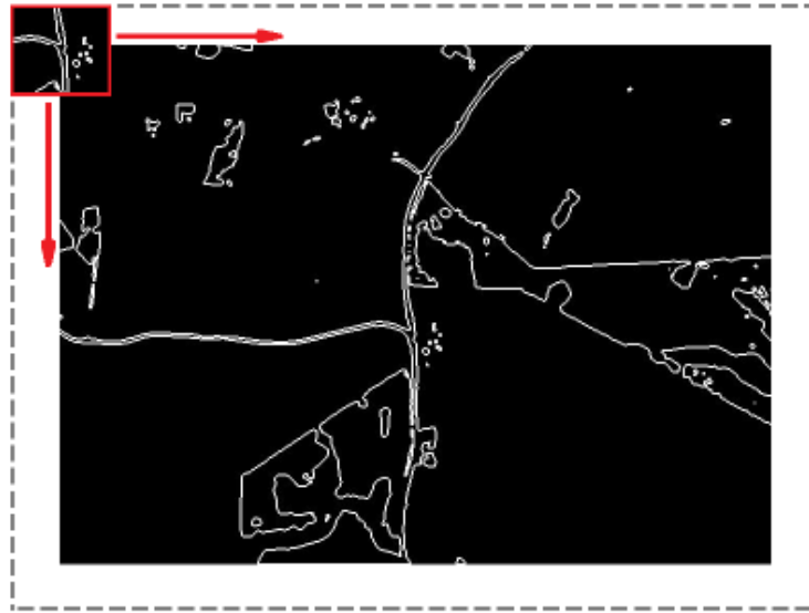
Figura 3.4 - Correlação cruzada entre a imagem do VANT e a imagem georeferenciada.
