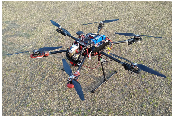
Figura 5.3 - Hexacóptero utilizado na realização dos experimentos em Monterrey, México.
