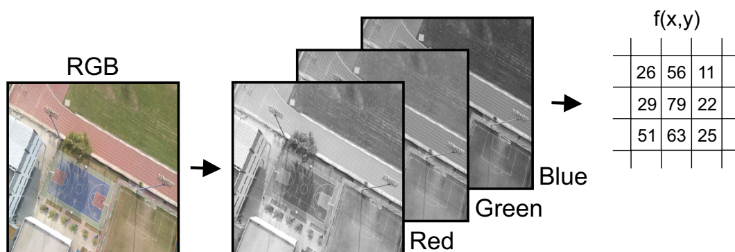
Figura B.1 - Estrutura de uma imagem RGB em suas bandas, vermelho, verde e azul.
