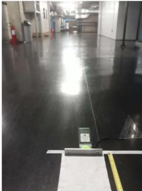
Figura 2 – Vista geral da calibração da trena digital
