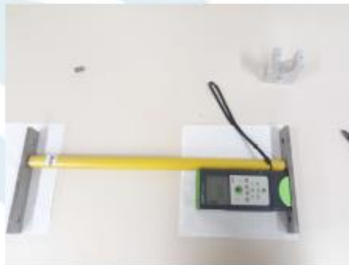
Figura 1 – Calibração da trena – ponto 1
