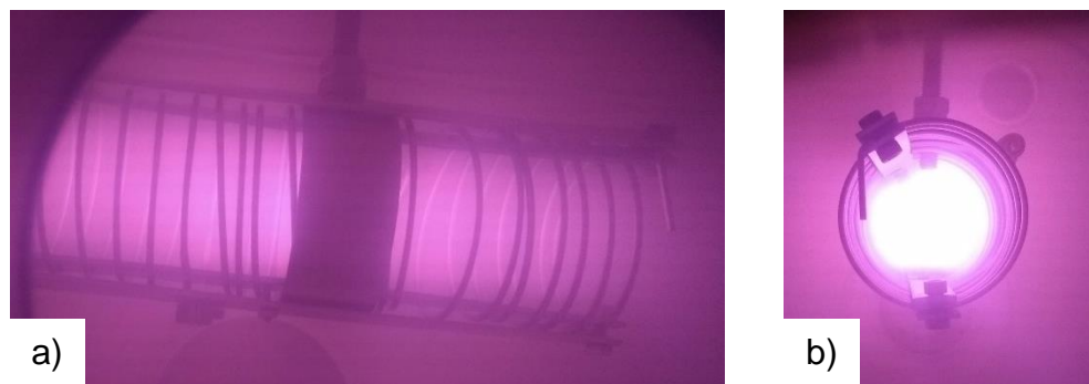
Figura A.7 – Fotos do tubo espiral no sistema 3IP-LAP com plasma: a) vista lateral e b) vista frontal.
