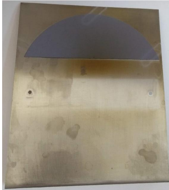
Figura 5.34 - Imagem do anteparo com lâmina de silício após o tratamento com 4 A e posicionadas à 4 cm de distância da extremidade do tubo.
