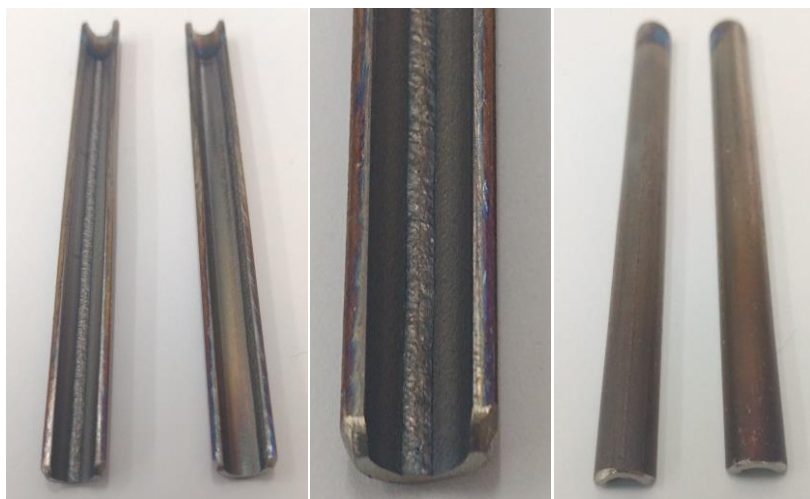
Figura 5.68 - Tubo de 0,6 cm de diâmetro após o tratamento com plasma de argônio.
