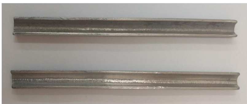
Figura 5.64 - Irregularidades no tubo de 0,6 cm de diâmetro.
