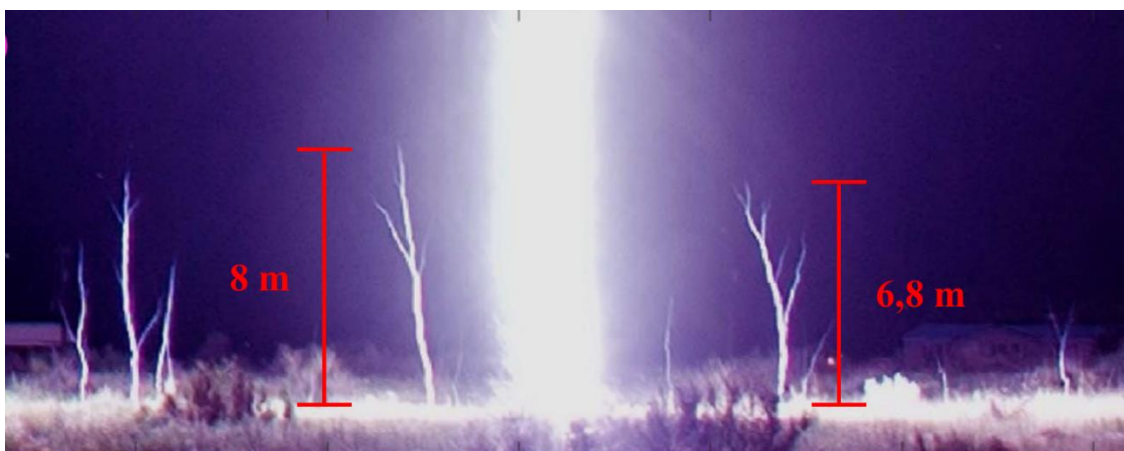
Figura 2.9 – Registros de conexões de raios descendentes com presença de LANCs.
