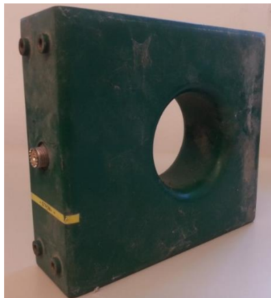
Figura 3.13 – Transformador de corrente da fabricante Pearson modelo 301X.
