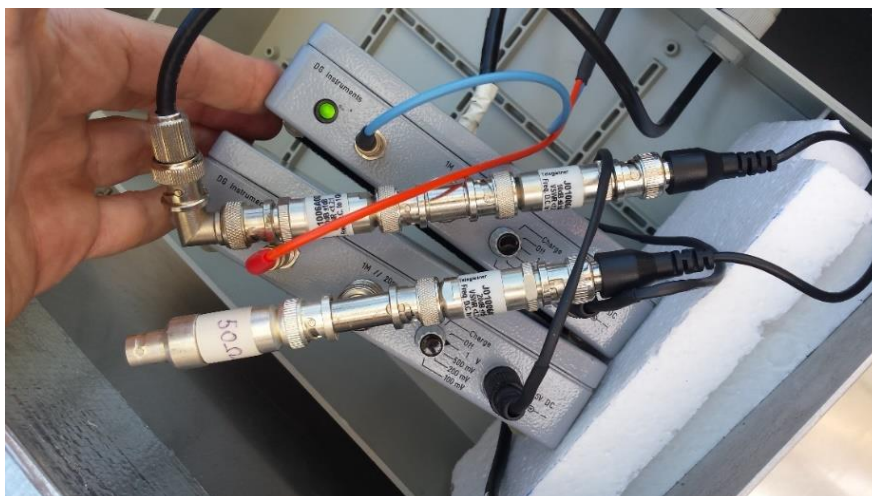
Figura 3.15 – Atenuadores e conversores de fibra óptica utilizados.
