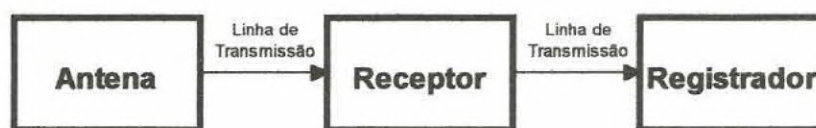
Figura 1.3 - Bloco esquemático de um sistema rádio-receptor para fins de estudos aplicados à Aeronomia.
