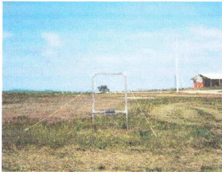
Figura 3.5 - Antena 'square loop' do receptor de ondas ELF/VLF do OES/CRSPE-INPE.
