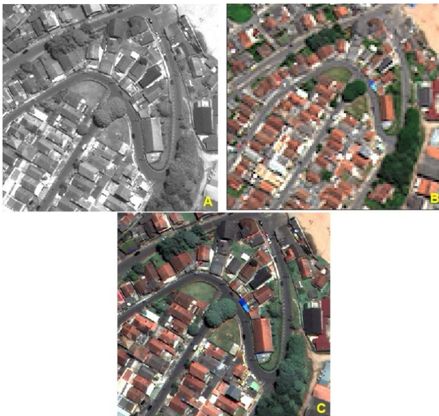
Figura 4.1. Recortes das imagens de entrada (A – banda pancromática e B – bandas multiespectrais, composição verdadeira R5G3B4) e C - resultado da fusão.
