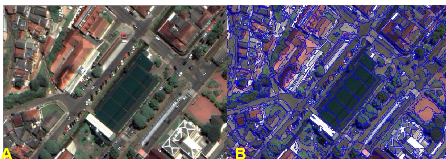
Figura 4.2. Segmentação da imagem: A - imagem composição verdadeira. B - imagem segmentada.
