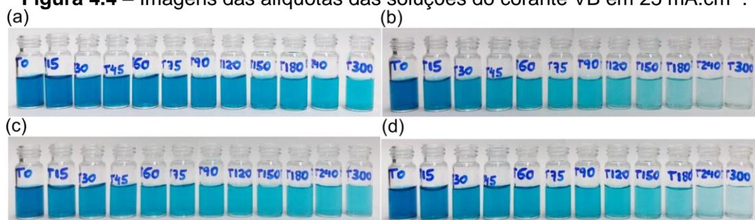
Imagens das alíquotas das soluções do corante VB para os eletrodos: (a) FC1000, (b) DDB/FC1000, (c) FC2000, (d) DDB/FC2000 na densidade de corrente de 25 mA.cm<sup>-2</sup>.
