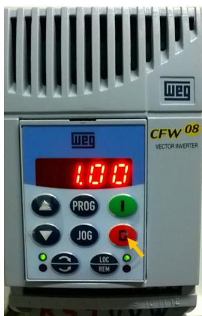
Figura 2.14. Posicionamento do botão vermelho no inversor de frequência.
