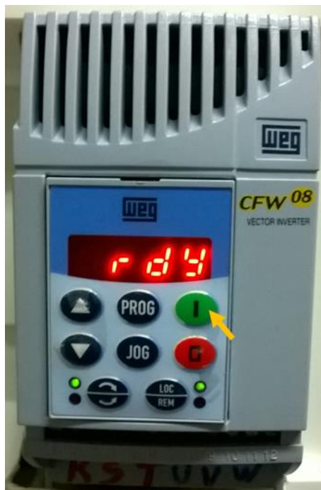
Figura 2.12. Posicionamento do botão verde no inversor de frequência.
