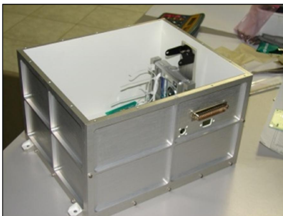
Figura 4.37 - Experimentos Educacionais em Microgravidade (EEM) com vista interna da caixa do experimento EEM.
