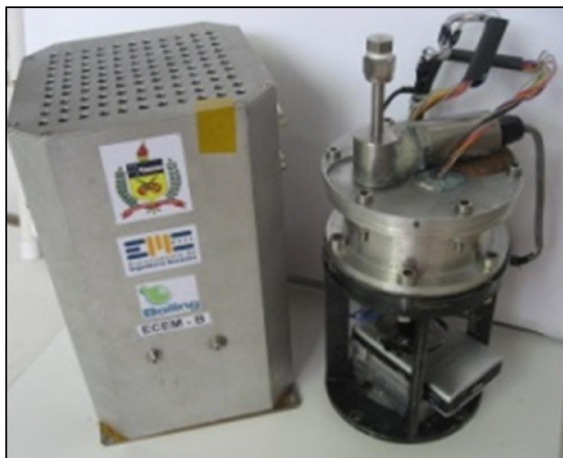
Figura 4.36 - Câmara de Ebulição sob Microgravidade (ECEM).
