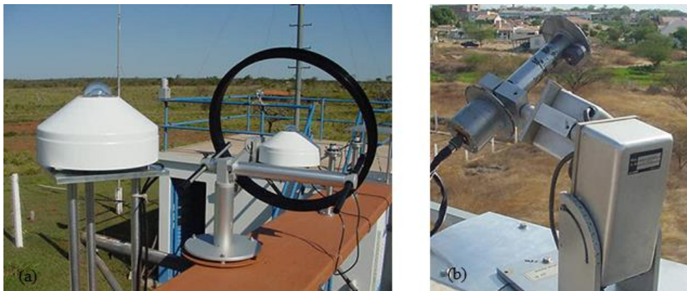
Figura 4 - (a) Piranômetros sem e com a banda de sombreamento e (b) Pireliômetro da Estação de Cachoeira Paulista. Fonte: INPE (2018).
